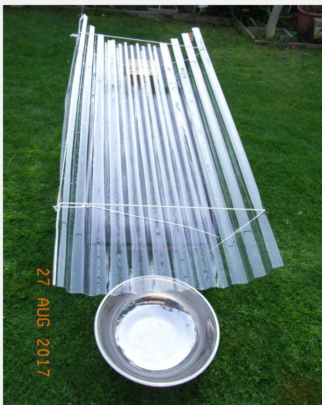
Fot. #C2: Mój prowizoryczny zestaw do łapania deszczówki, jaki w dniu 27 sierpnia 2017 roku zestawilem sobie poprzez przywiązanie sznurkiem do leżaka ogrodowego pofalowanej i przezroczystej tafli dachowej o
