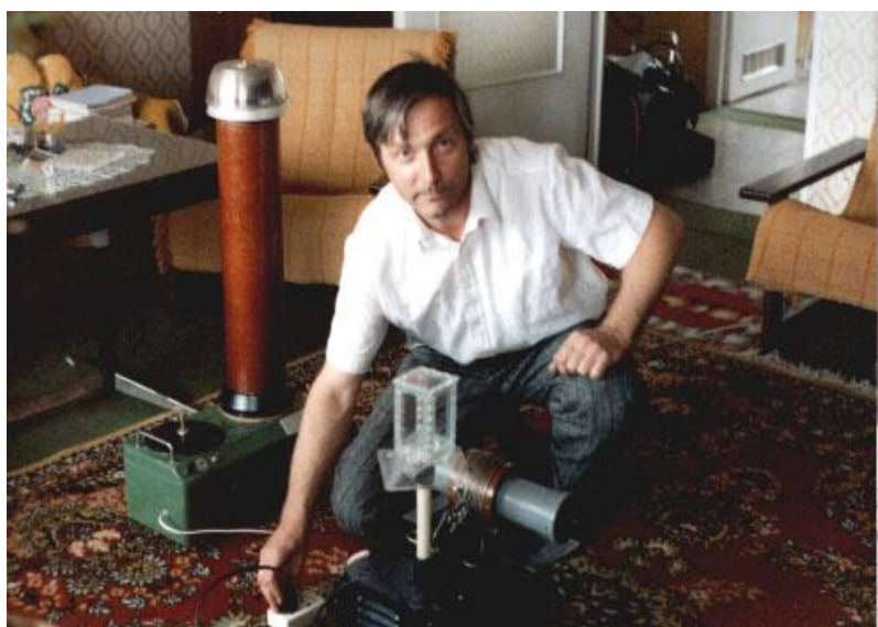
Rys. #G2 (F13(b) w [1/5]): Pokazuje ona polskiego hobbystę, który pracował nad rozwojem komory oscylacyjnej, razem z jego eksperymentalnym stanowiskiem badawczym składającym się z: badanego prototypu komory, generatora impulsów jaki dostarcza komorze jej mocy elektrycznej, elektromagnesu odchylającego, oraz urządzeń pomiarowych. Sfotografowano w sierpniu 1989 roku. Oryginalnie jest ona zaprezentowana w części (b) z rysunku F13 w [1/5].
