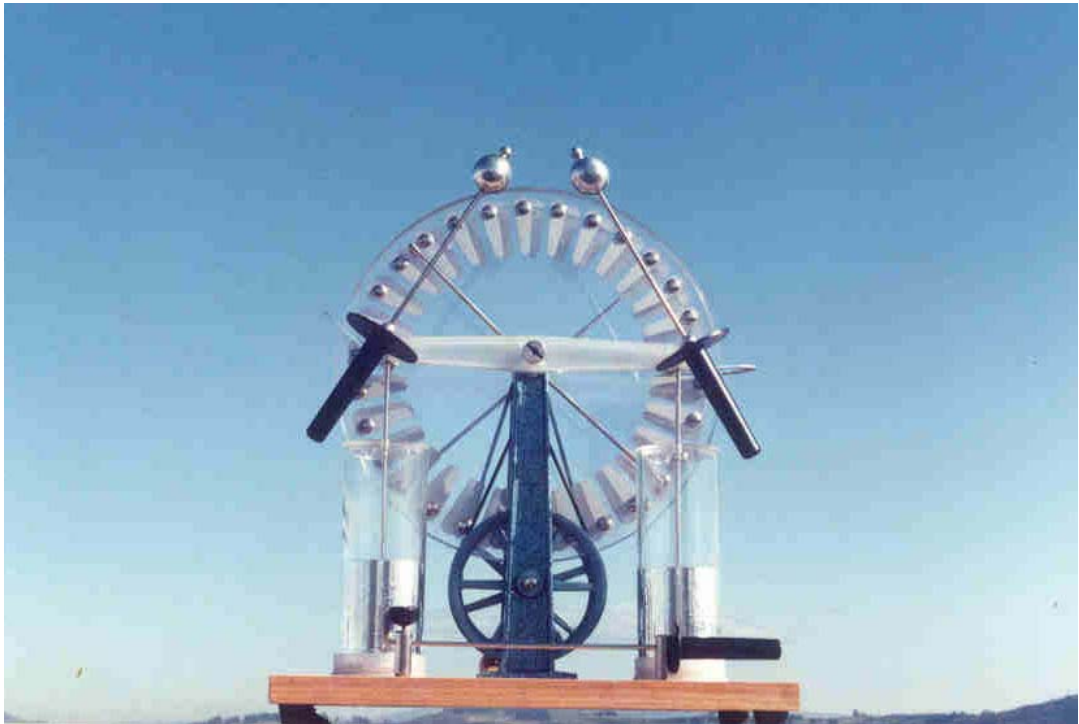
Rys. 9 z [6/2] a także ( Fig. #11 in [6/2e] ): Zdjęcie dydaktycznej maszyny elektrostatycznej Wimshurst'a, model V5-43, produkowanej przez Fabrykę Pomocy Naukowych w Nysie (adres: ul. Słowiańska 43, 48-300 Nysa, Poland; Tel: 2491). Powyższa maszyna "Wimshurst'a" posłużyła jako baza konstrukcyjna do wypracowania tzw: "Modelu Dra Pająka" maszyny elektrostatycznej, który pozwala na łatwe przetransformowanie w "influenzmaschine".
